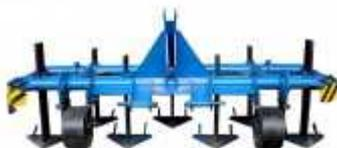
Плуг чизельный навесной предназначен для основной безотвальной обработки почвы различного механического состава на глубину до 60 см. Может использоваться для улучшения лугов и пастбищ, глубокого рыхления почвы на склонах и в низинах.
