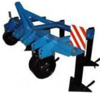
Плуг чизельный навесной ПЧН-3,2 предназначен для безотвальной вспашки (чизелевания) почвы, подрезания корневых сорняков, рыхления почвы в междурядьях виноградников и садов на глубину до 20 см. Плуг может применяться для обработки почвы различного механического состава не засоренной камнями и другими препятствиями с удельным сопротивлением до  $1,1 \text{ кг/см}^2$ , влажностью до 30%. Агрегируется с тракторами класса 3;4;5 т.с
