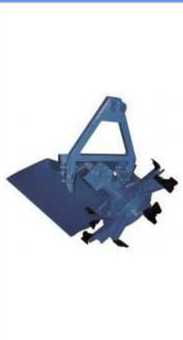
Каналокопатель МК-23А предназначен для формирования оросительных каналов на предварительно спланированной поверхности с односторонним формированием отвала грунта.
